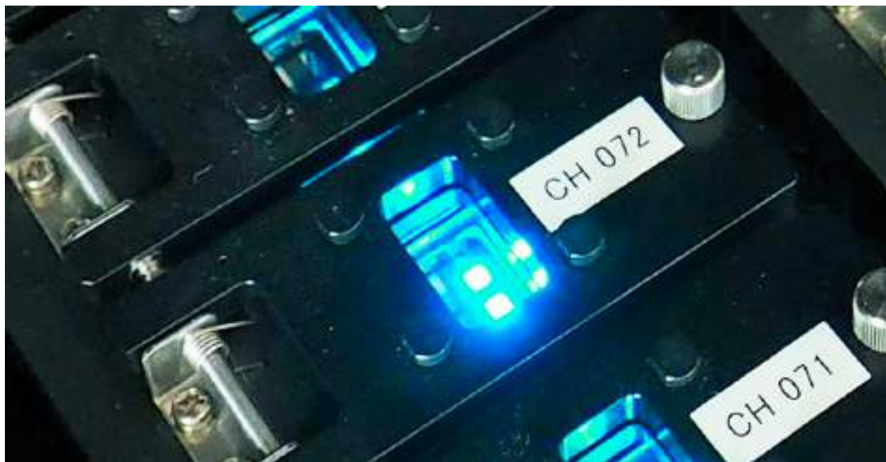
Los nuevos diodos orgánicos emisores de luz (OLED) ofrecen un azul más puro y una mayor eficiencia energética
